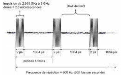
Schéma de principe : Signal mesuré par le Boeing RB-47H Stratojet "Lacy 17"
